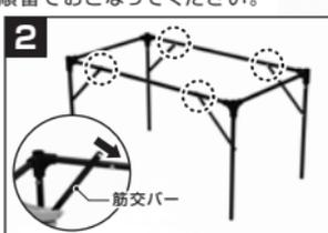
テーブルフレームの脚部に装着された4カ所の筋交バーを、上部4カ所のピンに引っ掛けます。
