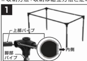
テーブルフレームを組み立てます。樹脂パーツに上部パイプと脚部パイプを差し込む際には、パイプの平たい面が内側になるように樹脂パーツに差し込んでください。
