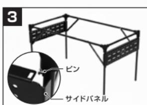
テーブルフレーム両側面に、サイドパネルを取り付けます。※脚部に固定されているピンの上に、サイドパネル上部のくぼみを差し込みます。
